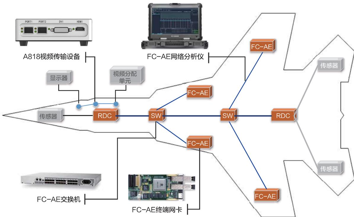
基于FC核心技术，华力创通提供FC-AE终端网卡、FC-AE交换机、A818视频传输设备以及FC-AE网络分析仪等产品，为FC-AE仿真开发、测试提供有效验证手段。
